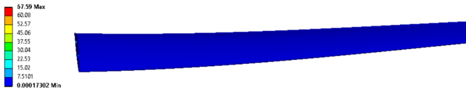
Fig. 20 Von -Mises Stress on Wing Skin
