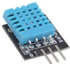
Fig. 3. DHT11 Sensor
